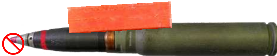
Вид типовой схемы укладки зарядов ВВ (200 г) для 23-мм и 30-мм патрона
