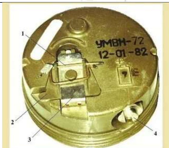
Рис. 19. Взрыватель ТМН-72 (внешний вид): 1 – шпилька; 2 – откидная ручка часового механизма; 3 – предохранительная чека; 4 – пробка гнезда источника тока.
