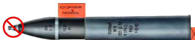
Вид типовой схемы укладки зарядов ВВ (600 г) для 76, 85-мм унитарных осколочно-фугасных выстрелов
