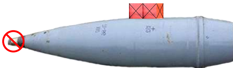
Вид типовой схемы укладки зарядов ВВ (1000 г) для 152-мм осколочно-фугасных снарядов раздельного заряжания
