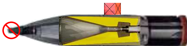
кумулятивные снаряды раздельного заряжания
